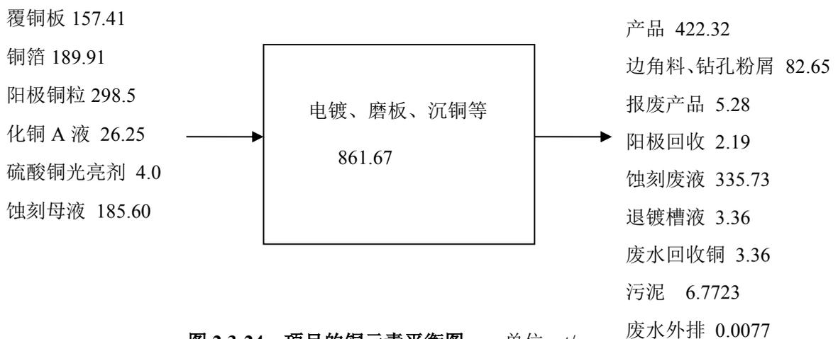
图 2.3-24 项目的铜元素平衡图 单位：t/a
